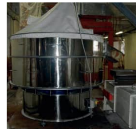
Aplicación de tamizado para separación de partículas en suspensión en forma de polvo (#150µ). Tamizadora adaptada para línea de lecho fluidizado
