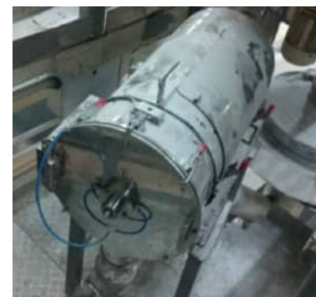
Ejemplo de tamizador centrífugo FTIC-0800 con malla de #300µ para tamizado de seguridad de mezcla de harinas en línea continua de ensacado.
