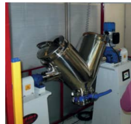
Mezcladora en UVE industrial FTIMV-100L, cuadro de maniobra integrado con autómatas programable y pantalla táctil para acceder al menú de programas editables. Dispuesto de barreras ópticas de seguridad.
