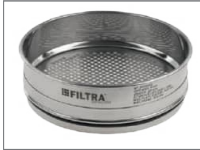
Tamiz de acero inoxidable con chapa perforada cuadrada.
