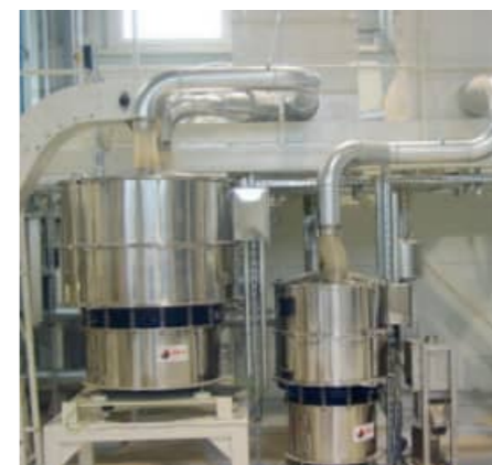
Ejemplo de aplicaciones de tamizado en línea con tamizadora FTI-1200 y FTI-0550 realizando trabajo en cascada.
